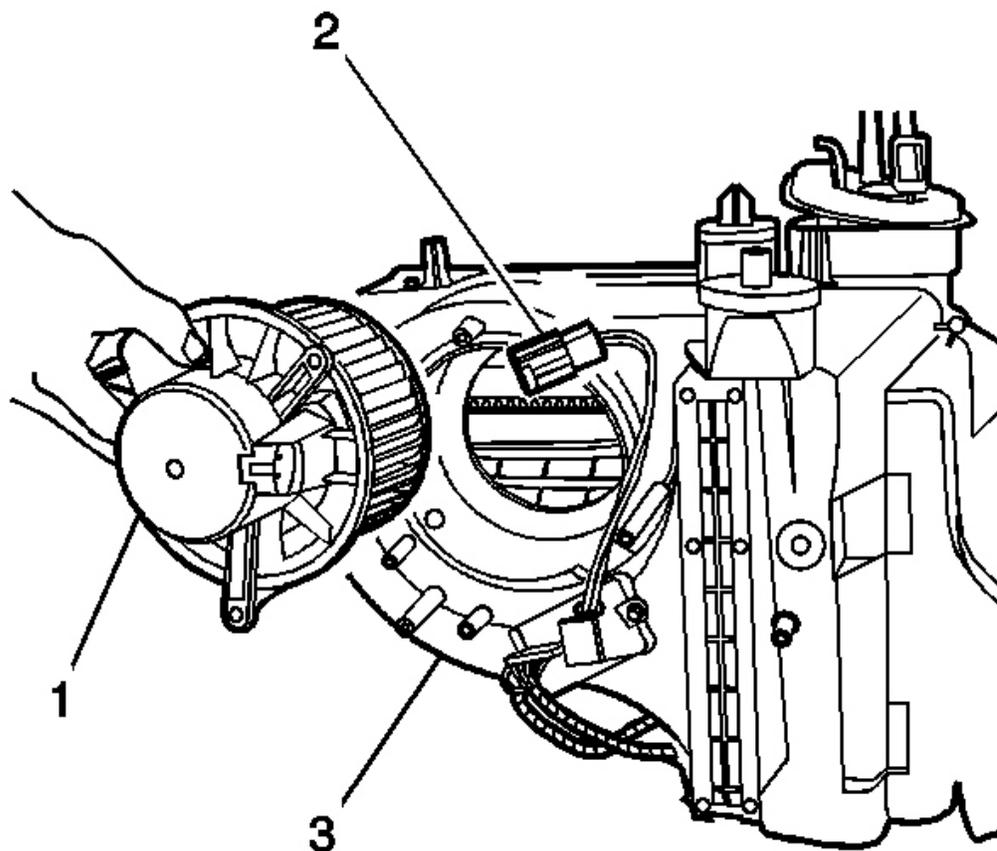
**Fig. 81: Blower Motor Assembly**
