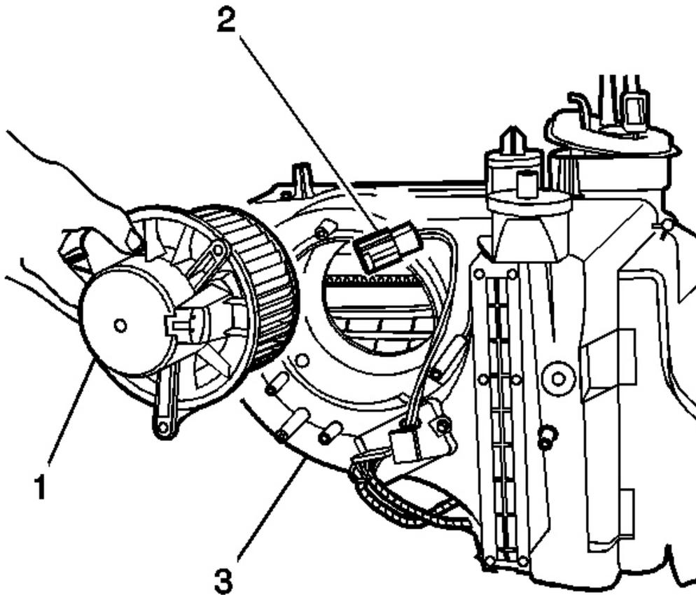
**Fig. 82: Blower Motor Assembly**
