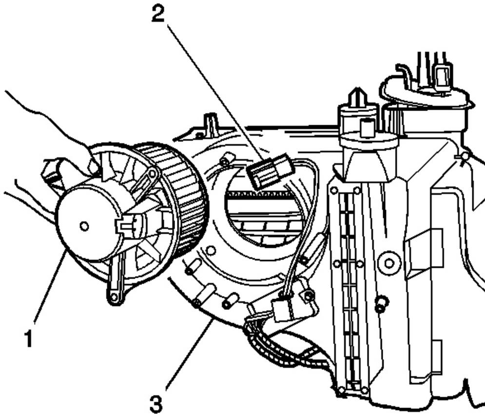
**Fig. 84: Blower Motor Assembly**
