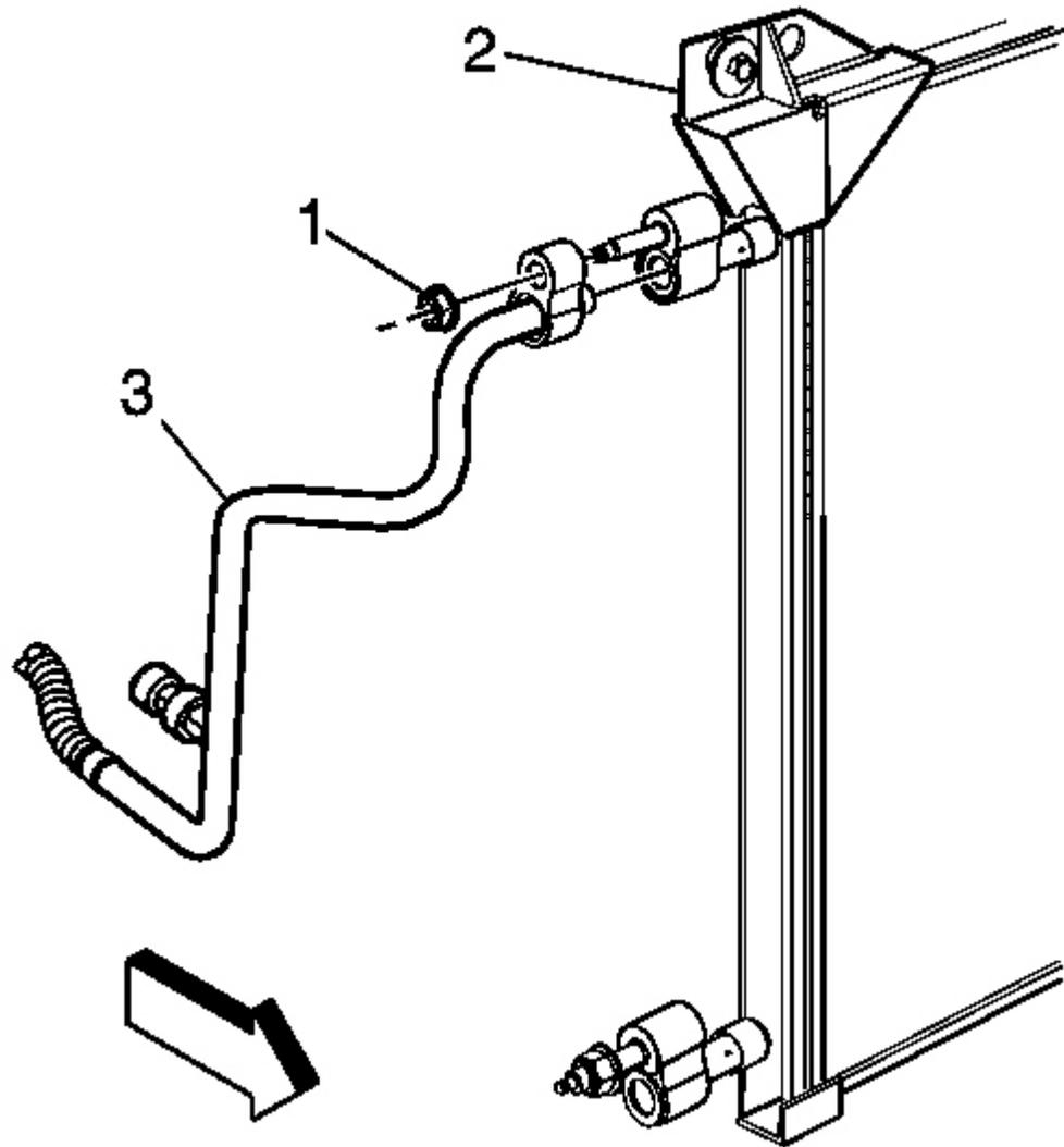
**Fig. 54: Discharge Hose Nut & Condenser**
