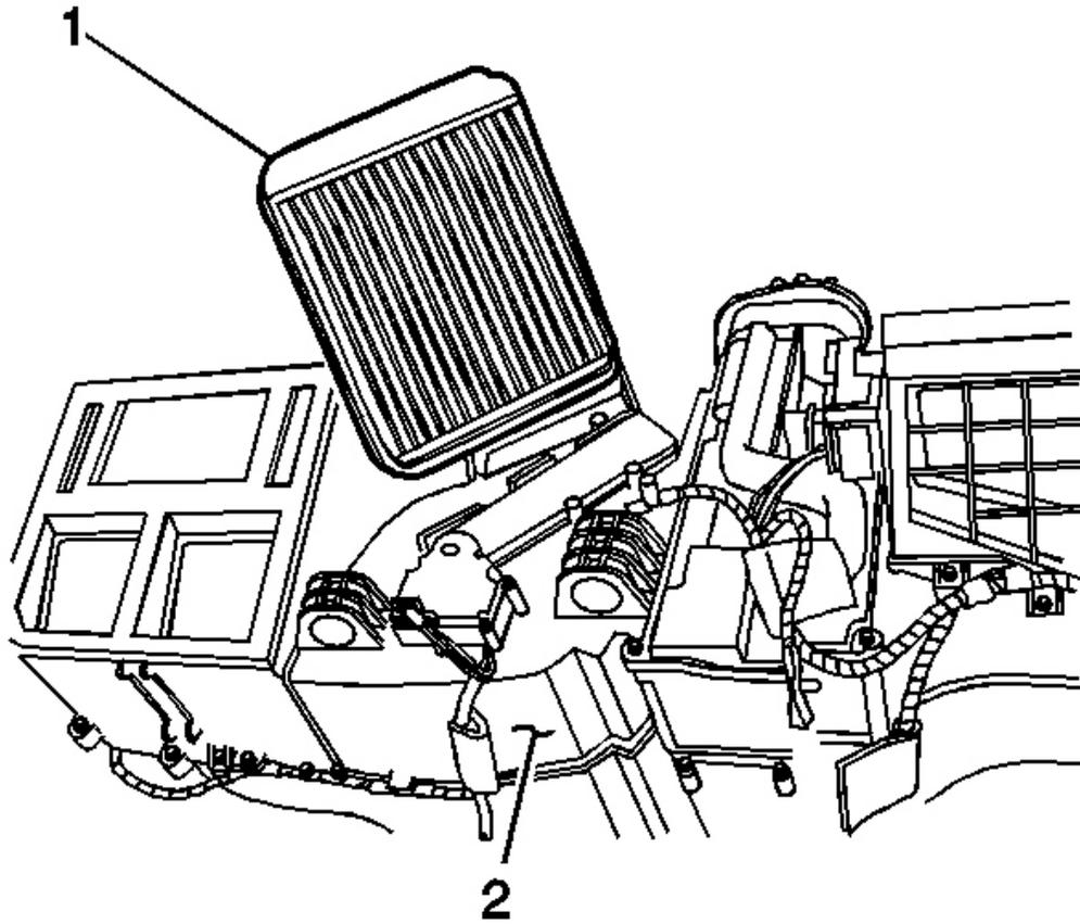
**Fig. 149: Heater Core**
