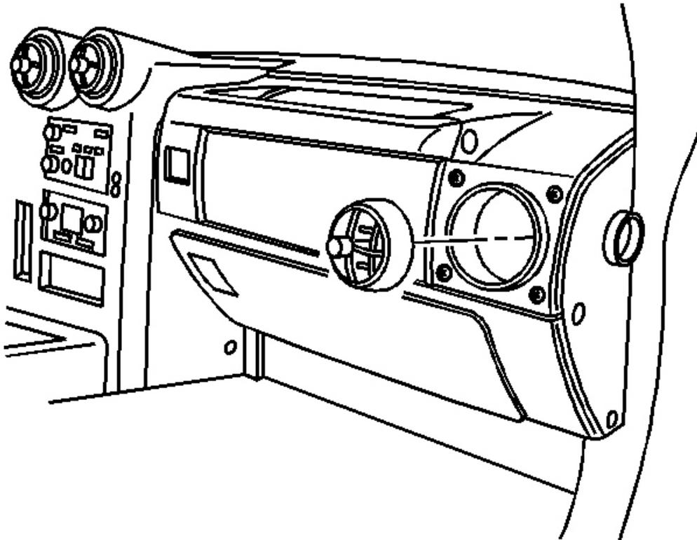
**Fig. 93: Air Reflector Louver & Trim Panel**
