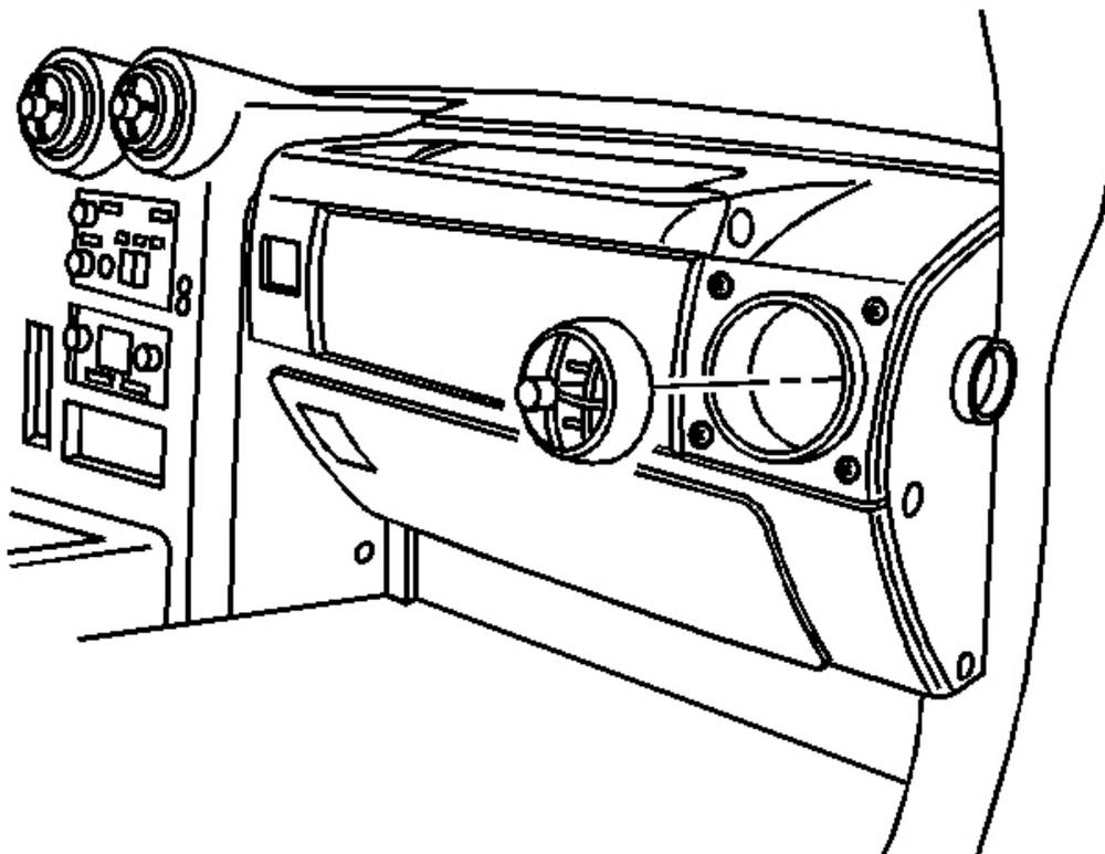
**Fig. 94: Air Reflector Louver & Trim Panel**
