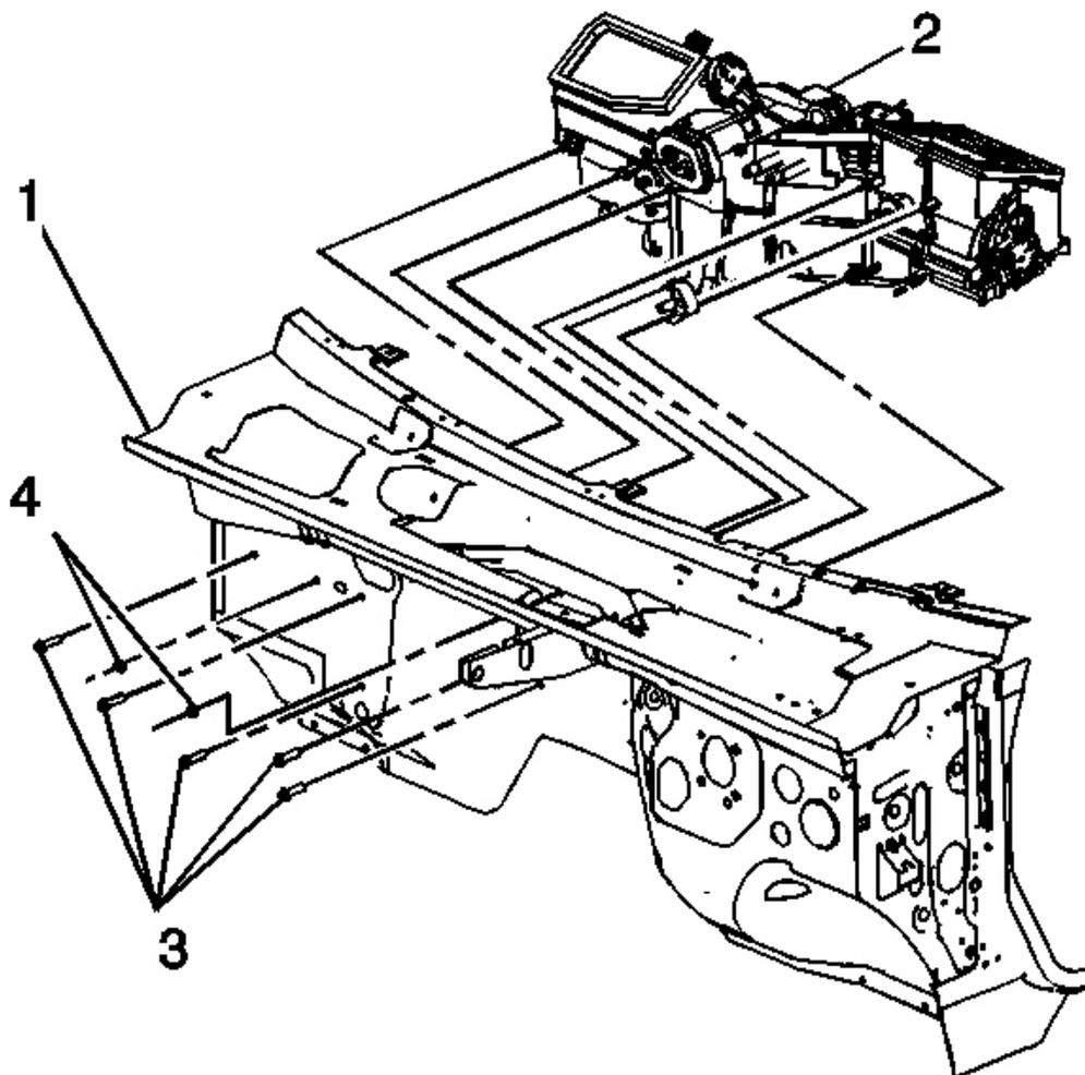
**Fig. 59: HVAC Module Assembly**
