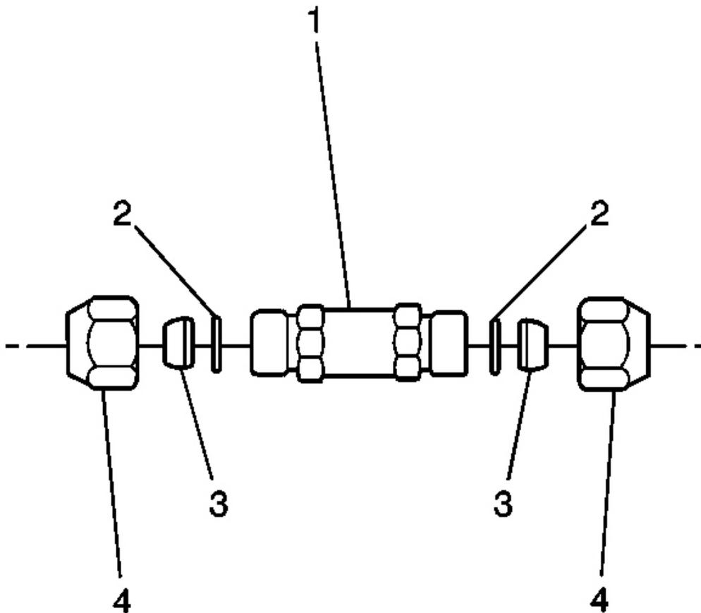
**Fig. 33: A/C Refrigerant Filter Components**
