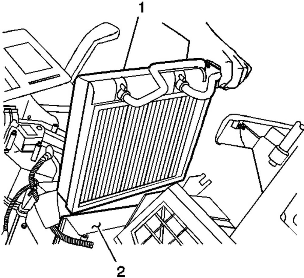
**Fig. 64: Evaporator Core & HVAC Module**
