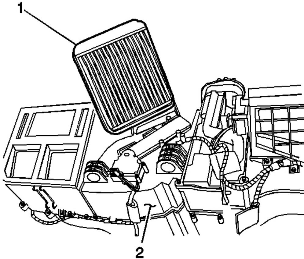
**Fig. 150: Heater Core**
