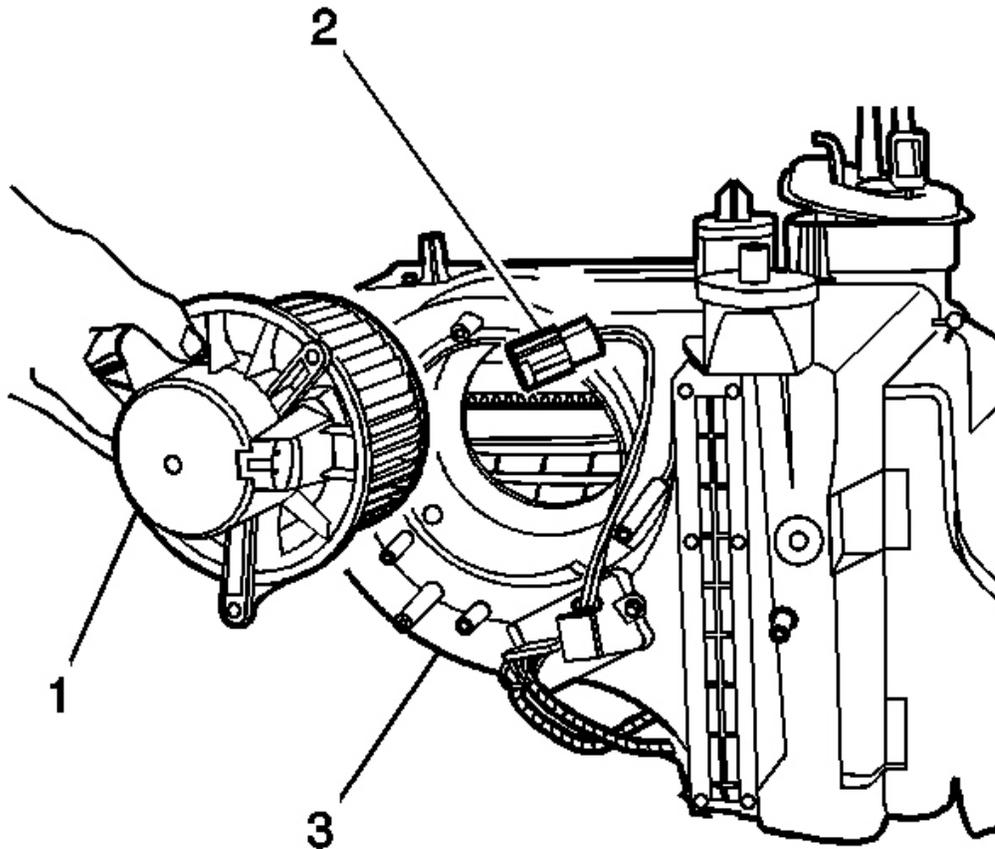
**Fig. 83: Blower Motor Assembly**
