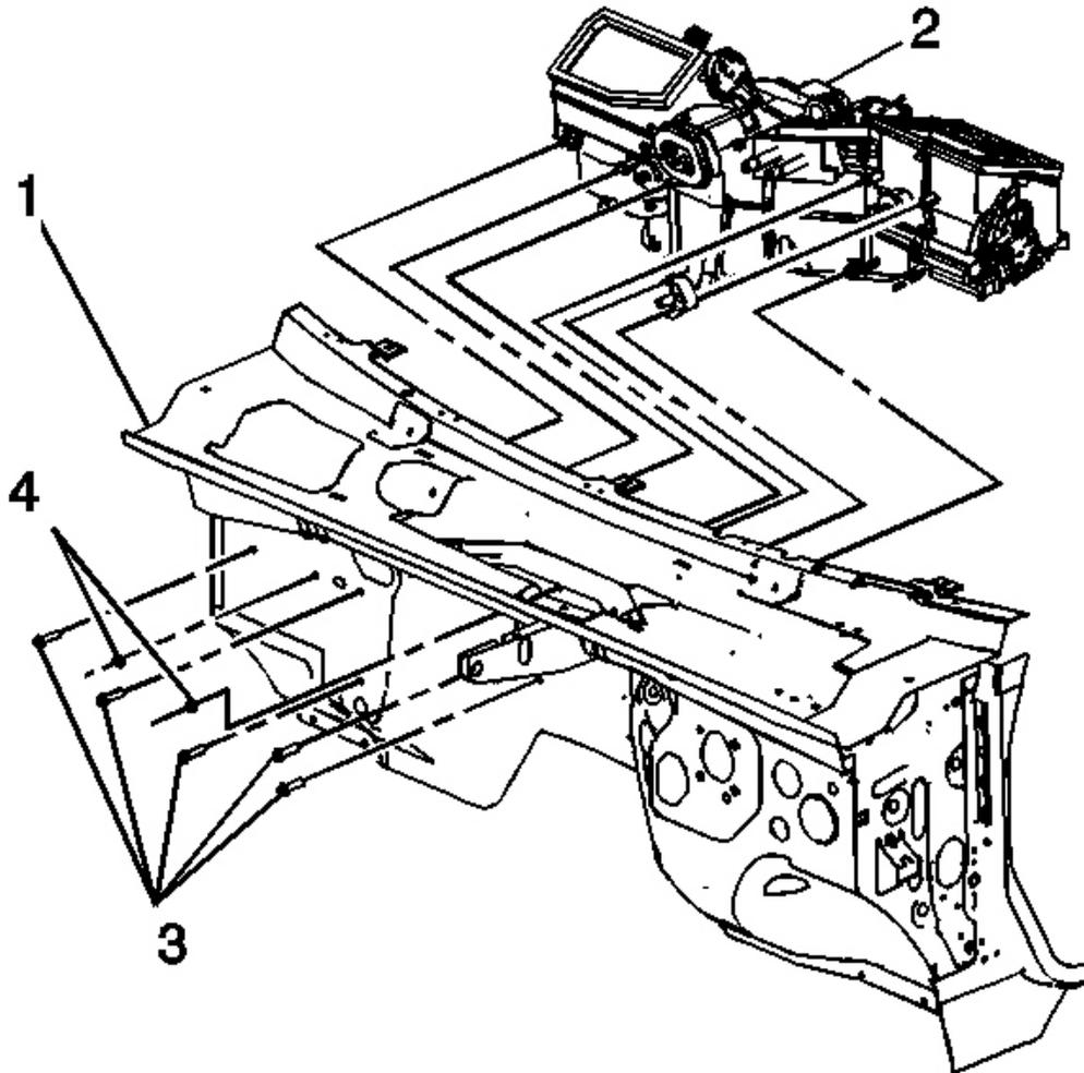
**Fig. 58: HVAC Module Assembly**
